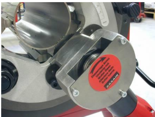
Montaggio dell'utensile all'esterno
