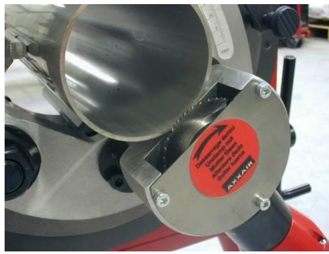
Montaggio dell'utensile all'esterno
