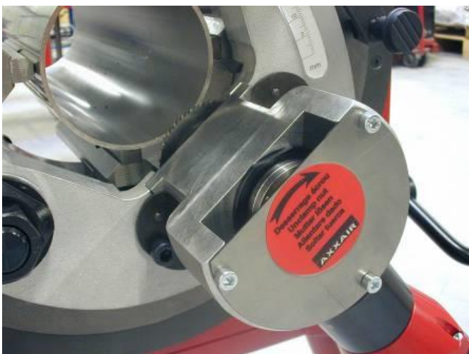
Montaje de la herramienta cerca de las mordazas
