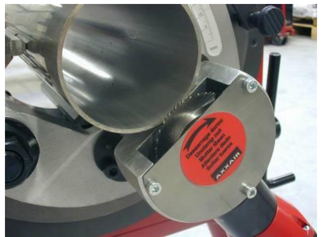
Außenmontage des Werkzeuges
